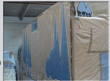
die Ränder unscharf werden. Außerdem war der Durchmesser der kleinsten Öffnungen über ein Zentimeter groß und die Anwendung der arbeitsaufwendigen selbstklebenden Schablonen scheint die beste Lösung zu sein. Nun habe ich alle Felder mit Gipskeramik mit einer Schicht Basislack in Elfenbeinfarbe überzogen. Dieselben Tätigkeiten habe
